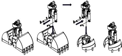
Schalen mit Schalenträger durch 3-Punkt-Stecksystem innerhalb der gesamten Baureihe austauschbar
