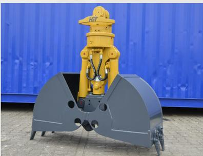
Universeller Greifer für den typischen Hydraulik-
