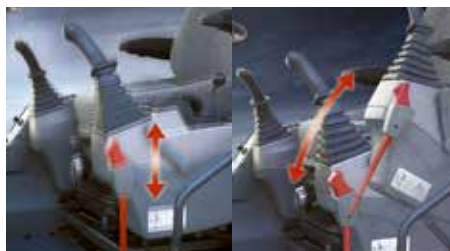
Control stand (mit Neigungs- und Höhenverstellung).
