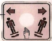
**Bei ertönen der Warnhupe ist die Maschine überhitzt. Entfernen Sie den Schmutz vor dem Kühler und aus dem Luftfilter.**
