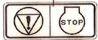
**Sicherheitsstoppschalter sollte am Körper des Bedieners befestigt sein.**
